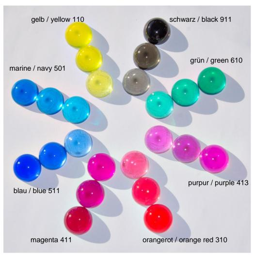
Abmischungen mit 0,1%, 0,2% und 0,5% Farbstoffzugabe / Mixtures with 0.1%, 0.2% and 0.5% dye addition
